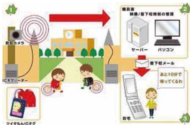
ICTタグによる防犯システム
